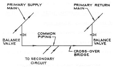
Figure 6 – CROSS-OVER BRIDGE; UNDERSLUNG
