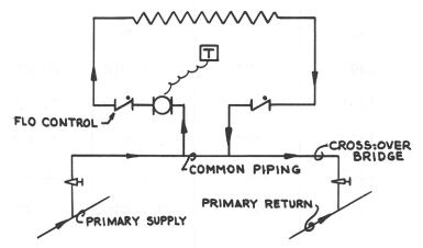
Figure 37 – START-STOP PUMP CONTROL FOR SPACE TEMPERATURE CONTROL
