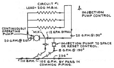
Figure 91 – INJECTION PUMP CONTROL
